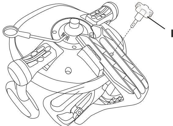
Закрепите спинку кресла при помощи фиксирующего винта
