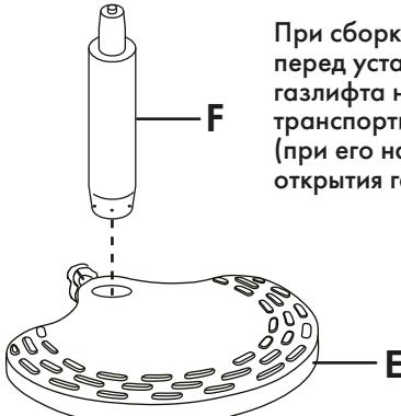
При сборке кресла перед установкой газлифта необходимо снять транспортировочный колпачок (при его наличии) с кнопки открытия газлифта!
